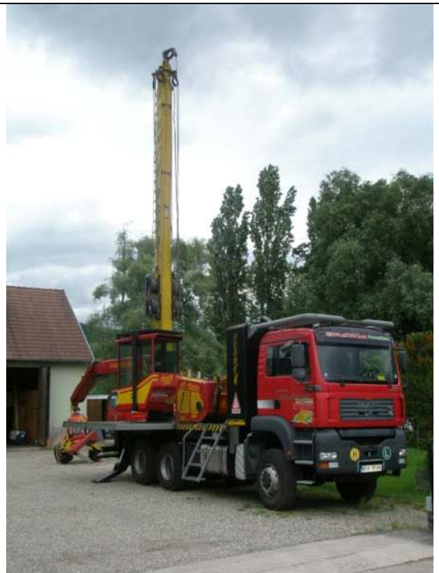
Ce camion doté d'un câble mât Woody comporte une grue et une tête de bûcheronnage
